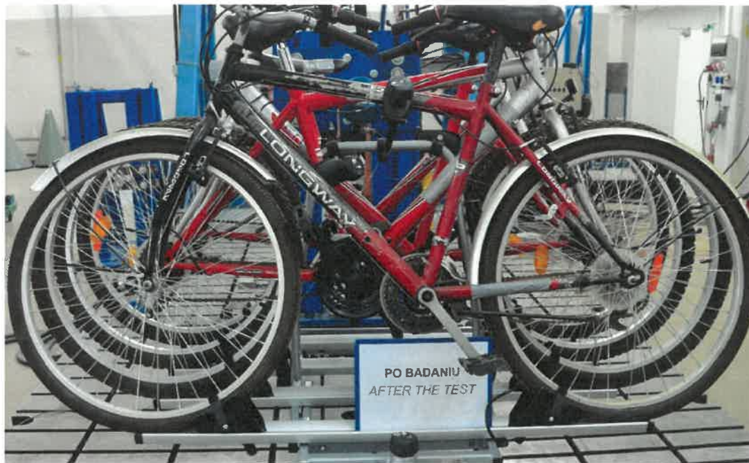
Fot. 1. Widok platformy Giro-4 Alu – badania statyczne
