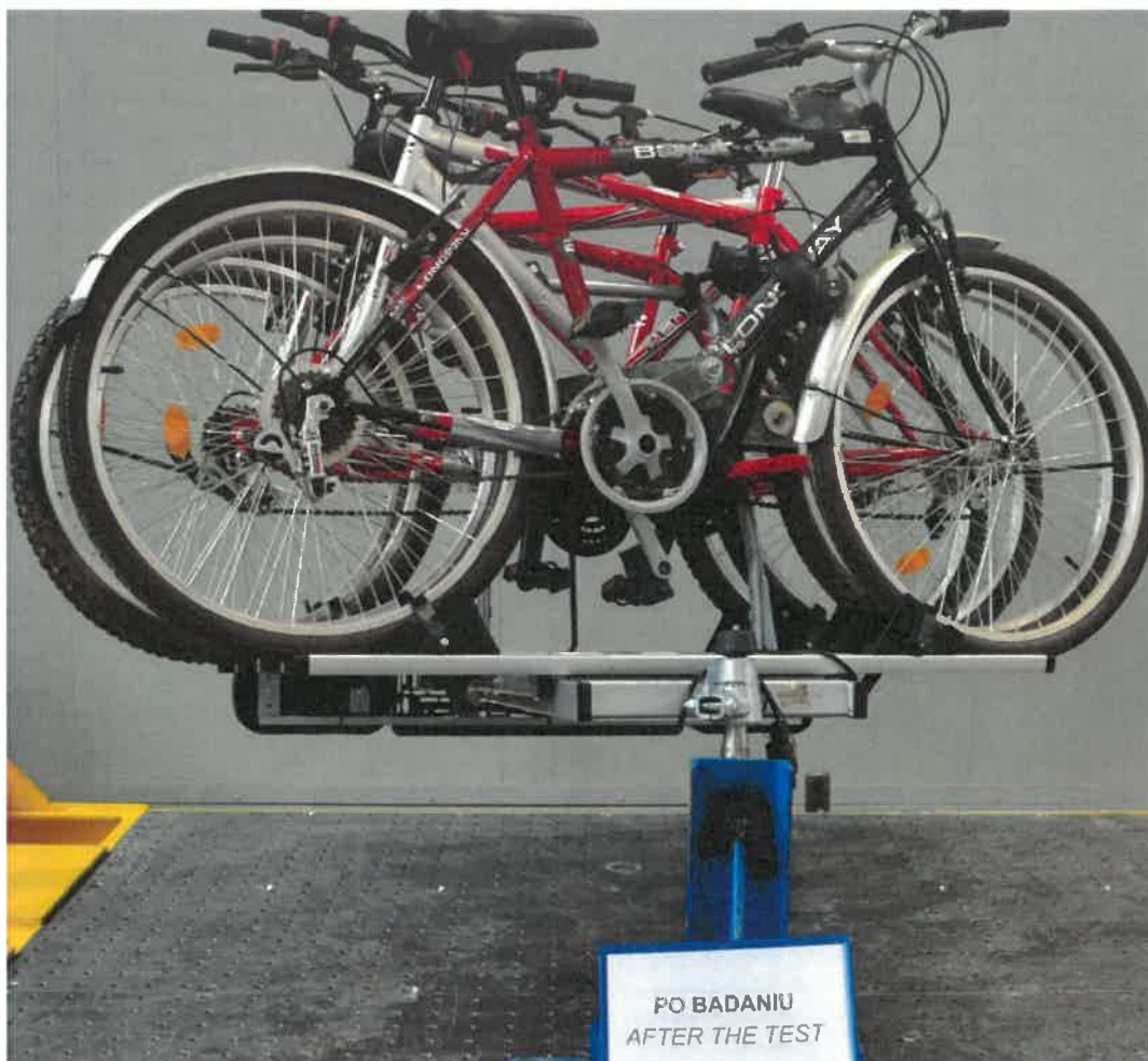
Fot. 3. Widok platformy Giro-4 Alu – badania dynamiczne w kierunku poprzecznym
