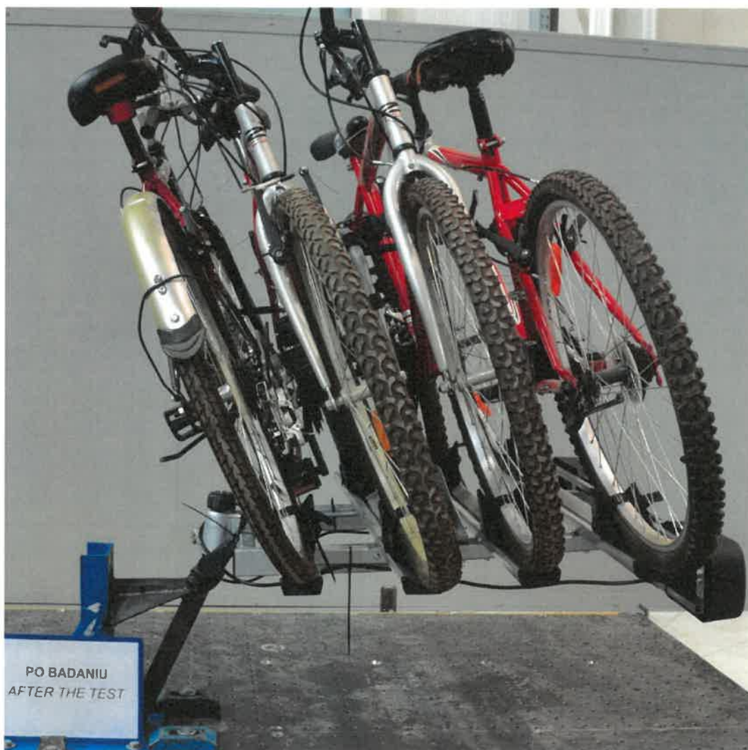
Fot. 2. Widok platformy Giro-4 Alu – badania dynamiczne w kierunku wzdłużnym
