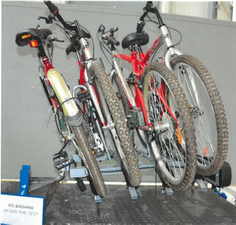
Fot. 2. Widok platformy Tytan-4 PLUS – badania dynamiczne w kierunku wzdłużnym
