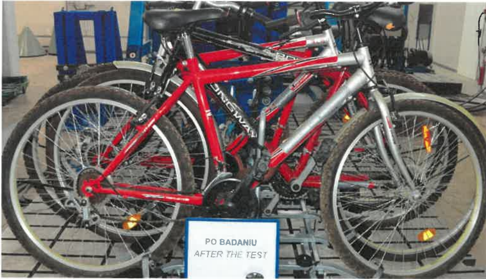
Fot. 1. Widok platformy Tytan-4 PLUS – badania statyczne
